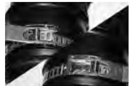
Band um das Abbindegut legen. Mit geringer Kraft freies Bandende hinunterdrücken, Spannhebel hin und herbewegen, bis Klemmverbindung gespannt ist. Spannhebel in geschlossene Position bringen. Die Arretierungssicke vermeidet unbeabsichtigtes Öffnen.
