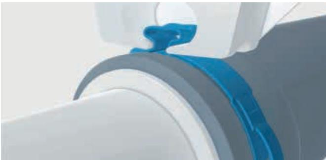
Für eine ordnungsgemässe Montage müssen die Zangenbacken am „Ohr“ der Klemme platziert werden. Die Zangenbacken schliessen, um das Klemmenohr zu komprimieren. Dies reduziert den Durchmesser der ToothLock® Ohr Klemme. Das Werkzeug kann entfernt werden, wenn die Zangenbacken offen sind, nachdem das Ohr geklemmt wurde.
