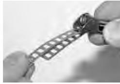
Bandende von oben durch den Schlitz für die Bandbefestigung schieben und ca. 30 mm unter das Band zurückführen.
