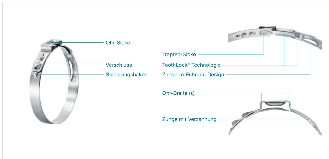
**ToothLock® Technologie:** sehr hohe und dauerhafte Kompressionsraten, überlegene Radiallastkennwerte, hoher Druck- und Expansionswiderstand
