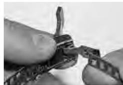
Spannhebel in geöffnete Position bringen und freies Bandende der Krümmung des Schlosses anpassen. Verformtes Bandende unter der Zunge hindurchführen, sodass das Bandende über dem Spannverschlusskörper liegt.
