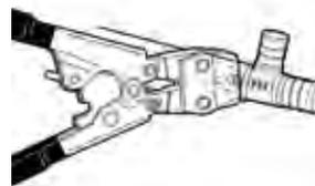
Streifen Sie die Klemme über das Rohr und schliessen Sie das Klemmenohr dann mit dem Werkzeug. Das Werkzeug öffnet sich erst, wenn die Klemme vollständig geschlossen ist.
