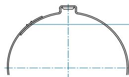
Version Verschluss aussenseitig kann eine einfachere Montage ermöglichen.
