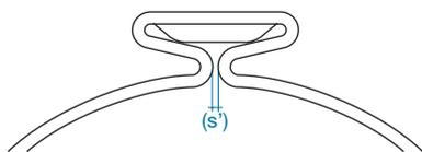
Die Darstellung erhebt keinen Anspruch auf vollständige Schliessung des Klemmenohrs (s'), sondern dient lediglich der skizzenhaften Visualisierung einer geschlossenen Klemme.
