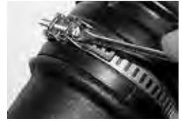
Klemmverbindung mit Schraubendreher oder Sechskantschlüssel spannen.
