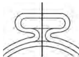
Führen Sie eine Sichtkontrolle an der Klemme durch, um eine korrekt geschlossene Ohrenform sicherzustellen.
