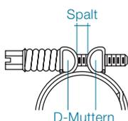
**Toleranzkompensation bei StepLess® Schraubschellen**
