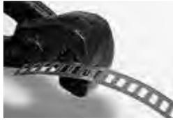
Bandlänge abschneiden. Um Verletzungen zu vermeiden, sollten scharfe Kanten mittels Feile entgratet und Ecken gehast werden.
