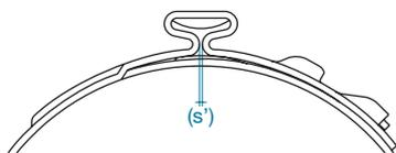
Hinweis: Die Darstellung erhebt keinen Anspruch auf vollständige Schliessung des Klemmenohres (s'). Sie visualisiert die geschlossene Klemme lediglich skizzenhaft.
