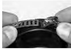
Band um das Abbindegut legen. Freies Bandende über Einhängen und unter der Schraube positionieren. Das Bandende kommt unter dem Schraubkörper zu liegen. Einhängen in engster Position einhängen.
