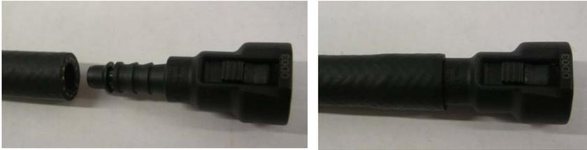
Passende Einohrklemme montieren, Ohr zudrücken bis Schlauchverpressung sichtbar
