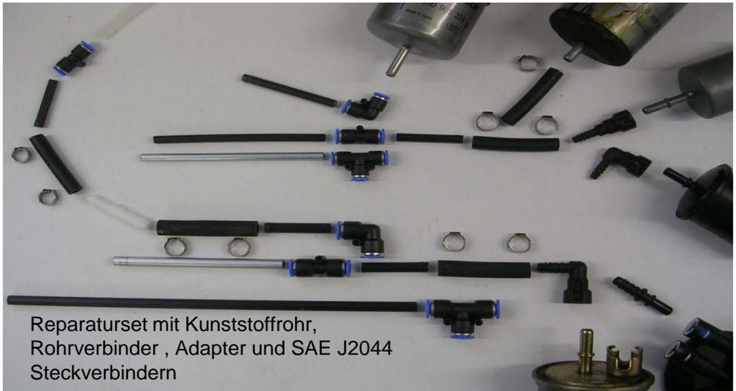
Reparaturset mit Kunststoffrohr, Rohrverbinder, Adapter und SAE J2044 Steckverbindern
