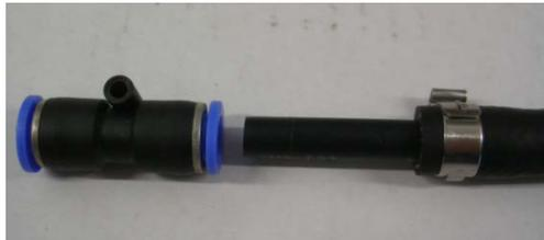
Rohrverbinder mit Rohradapter verbinden
